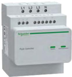
L'EVlink Home Peak Controller est un système de régulation de la charge électrique qui ajuste en permanence l'énergie fournie au véhicule par la borne de recharge à la puissance disponible du raccordement domestique. La puissance disponible est calculée par le Peak Controller en comparant la limite de puissance du fournisseur d'électricité avec la consommation domestique, mesurée par un convertisseur de courant placé sous l'interrupteur principal.
