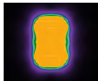
LO: Éclairage d'un terrain de sport avec projecteurs à lumière diffuse limitée (LO)
