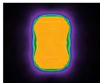
LO: illuminazione di un campo sportivo con proiettori con limitazione della luce diffusa (LO)
